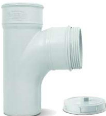
دریچه بازدید فاضلاب برای رفع گرفتگی لوله ها و سیفون و زانوها، تخلیه چاه ها و تمیز کردن آن ها در ساختمان استفاده می شود، که با وجود این دریچه لازم نیست لوله شکافته شود. دریچه بازدید در پایین ترین نقطه هر لوله فاضلاب قائم، در سر زانو سه راه ها موقع اتصال یک لوله فرعی به لوله دیگر در هر تغییر مسیر در لوله های اصلی فاضلاب ساختمان که از دیوار خارجی عبور می کنند، نصب می شود.
