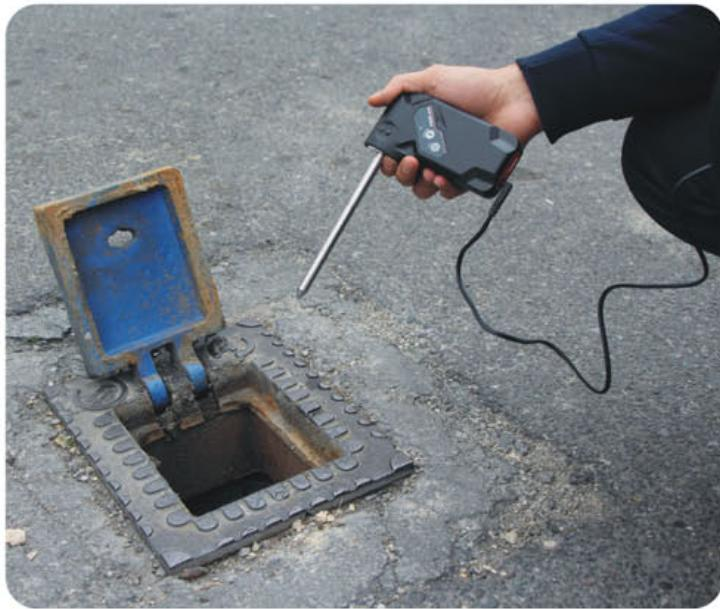
دستگاه نشت یاب آکوستیک آب پریجا مینی در چندین مدل عرضه شده است مدل PERIJA mini VPRO به طور تخصصی جهت بررسی وجود نشت از نقاط دسترسی به شبکه همانند کنترلرهای مشترکین، شیرخانهای کنترلی شبکه و شیرهای آتش نشانی می‌باشد. این دستگاه با ببره‌گیری از سنسور بسیار حساس بعنوان یک آشکارسازی صوتی، اندازه گیر و پیش‌بینی نشت یاب هوشمند تست شبکه بوده و با هر اتصال برروی شبکه فلزی تا شعاع ۱۰۰ متر و در شبکه‌های پلی‌اتیلن تا شعاع ۳۰ متر وجود نشت را تشخیص می‌دهد.
